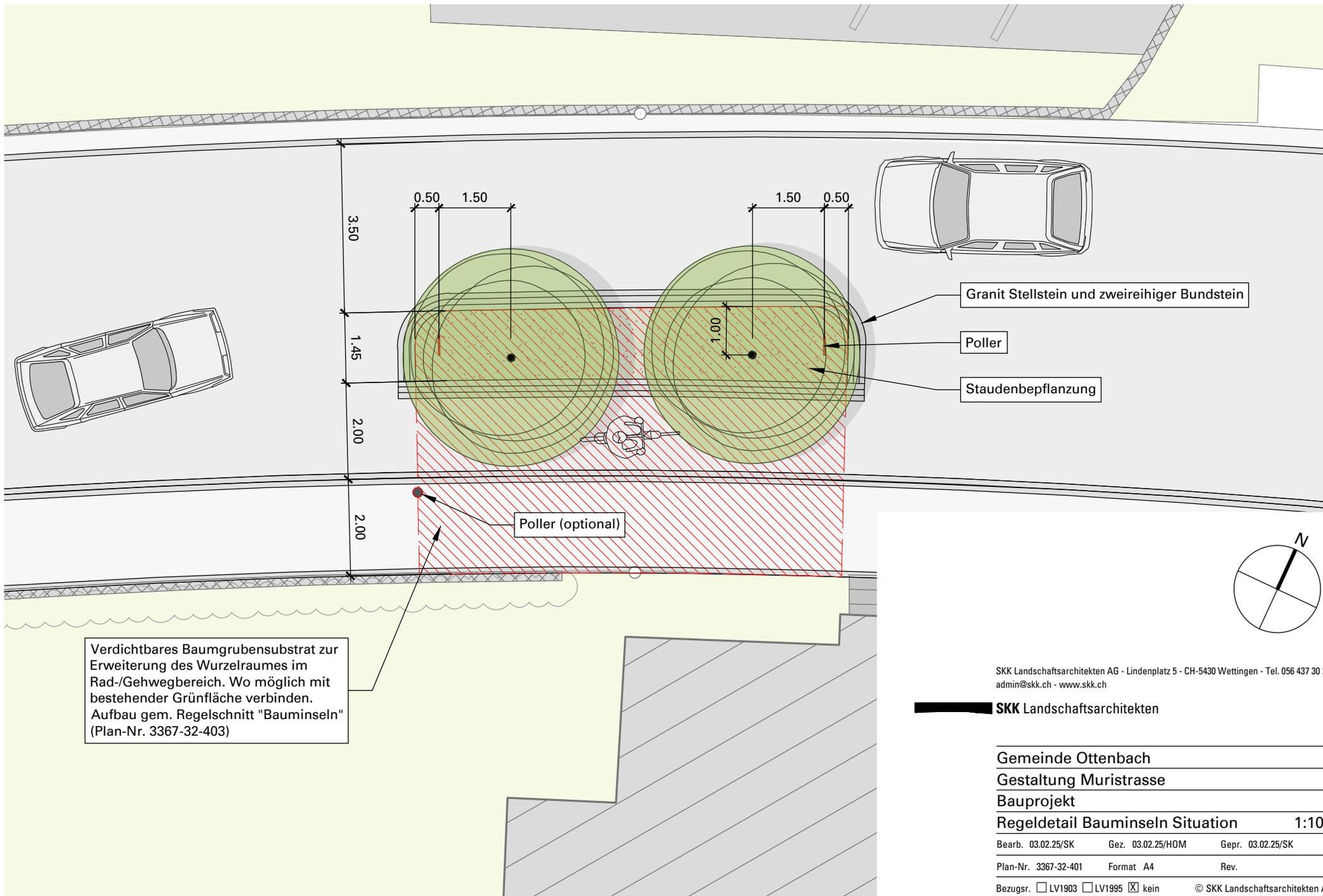
Verdichtbares Baumgrubenssubstrat zur Erweiterung des Wurzelraumes im Rad-/Gehwegbereich. Wo möglich mit bestehender Grünfläche verbinden. Aufbau gem. Regelschnitt "Bauminseln" (Plan-Nr. 3367-32-403)
